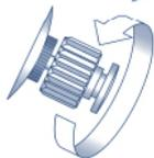
B: Svitare la corona ⑥ in senso antiorario, in questo modo si innesta automaticamente il meccanismo che agisce sulla ghiera girevole bi-direzionale ①. A questo punto è possibile far coincidere l'indice dello zero ④ con la lancetta dei minuti ③. In questo modo si ottiene, da quel momento, la possibilità di visualizzare costantemente il tempo trascorso durante l'immersione o in qualsiasi altra situazione. Per maggiore visibilità i primi 15 minuti indicati sulla ghiera sono ad alta luminescenza.
